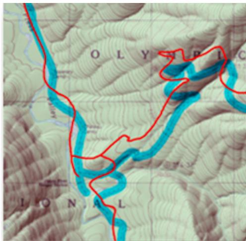
Figura 5.26.: Desplazamiento de mapa causado por las mismas coordenadas, pero diferentes sistemas de referencia. Ejemplo proporcionado por Petrosys LTD, [www.petrosys.com.au/](http://www.petrosys.com.au/)
